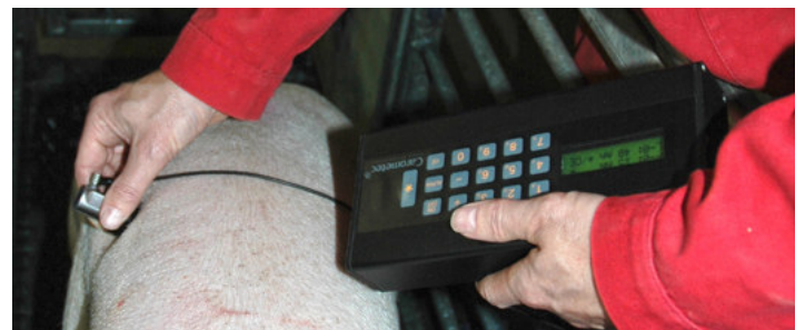
Abb. 2: Ultraschallmessung mit dem Gerät PIGLOG
