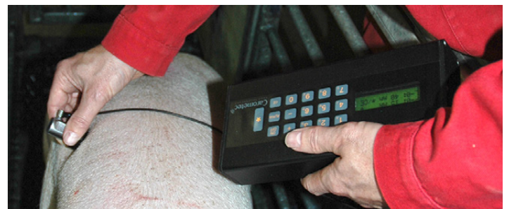
Abb. 2: Ultraschallmessung mit dem Gerät PIGLOG
