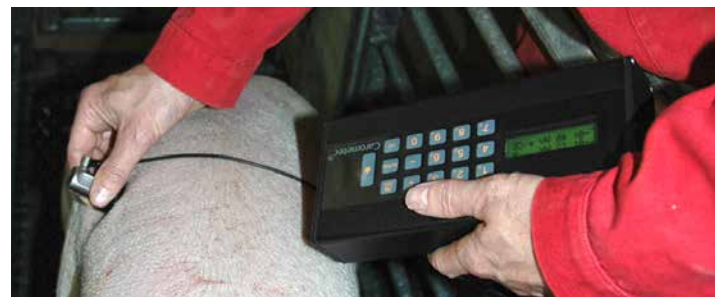
Abb. 2: Ultraschallmessung mit dem Gerät PIGLOG
