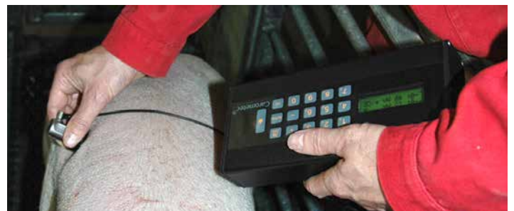
Illustr. 2: Mesure à ultrasons avec l'appareil PIGLOG
