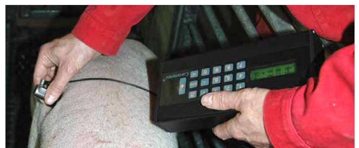
Illustr. 2: Mesure à ultrasons avec l'appareil PIGLOG
