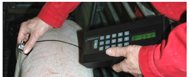
Illustr. 2: Mesure à ultrasons avec l'appareil PIGLOG
